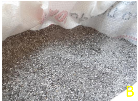
Figura 3: (A) Pilão que pode servir para triturar a cinza de osso (B) Cinza de osso triturada, e pronta para uso.
