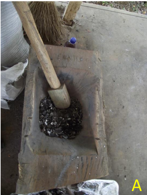
Figura 3: (A) Pilão que pode servir para triturar a cinza de osso (B) Cinza de osso triturada, e pronta para uso.
