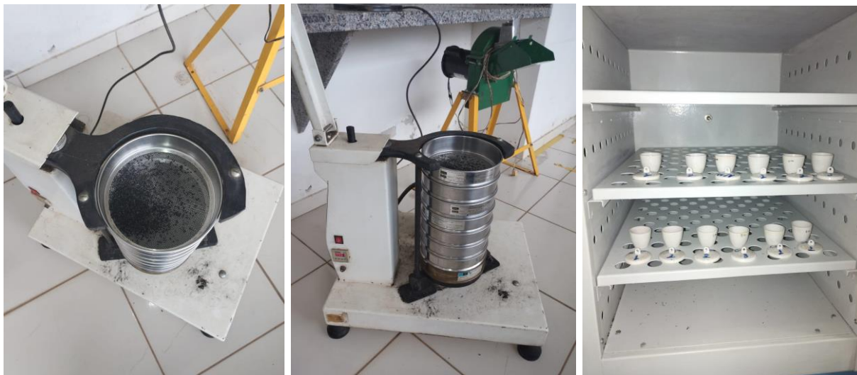
Figura 3. Homogeneização dos biochars produzidos a partir de resíduos agroindustriais em agitador mecânico e posterior secagem do material em estufa.
