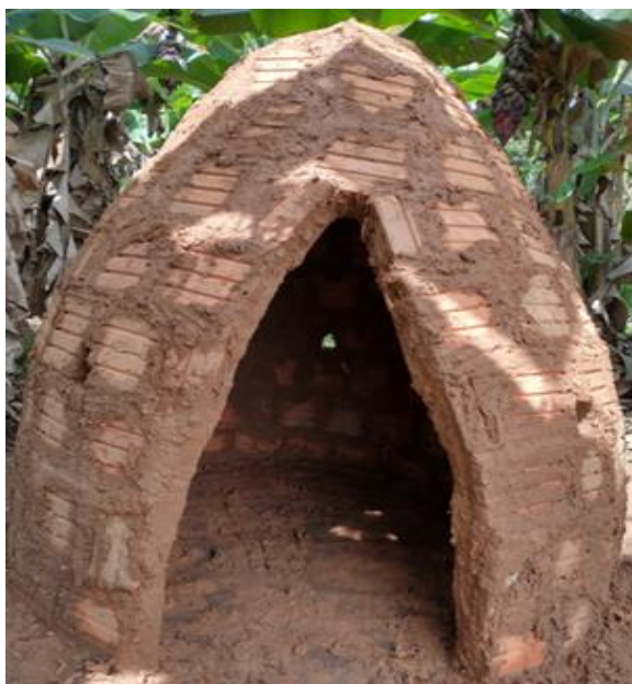
Figura 1. Forno de pirólise artesanal utilizado para produção de biochars produzidos a partir de resíduos agroindustriais
