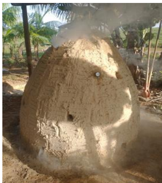
Figura 1. Forno de pirólise artesanal utilizado para produção de biochars produzidos a partir de resíduos agroindustriais
