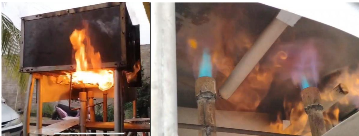
Figura 1 – Forno do tipo caixote utilizado na produção do biocarvão a 700 °C.
