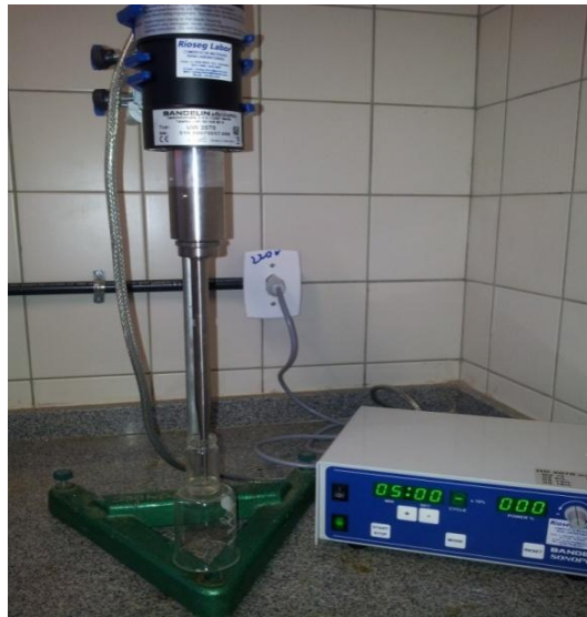
Figura19. Formação da nanoemulsão de OECC usando método de alta energia no aparelho sonificador. Foto- Jason J. Atoche
