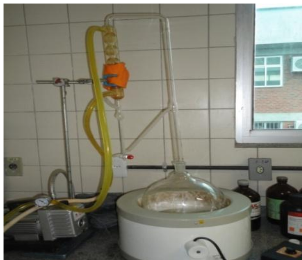
Figura 9. Sistema clevenger modificado para extração de óleo essencial. Foto- Jason J. Atoche
