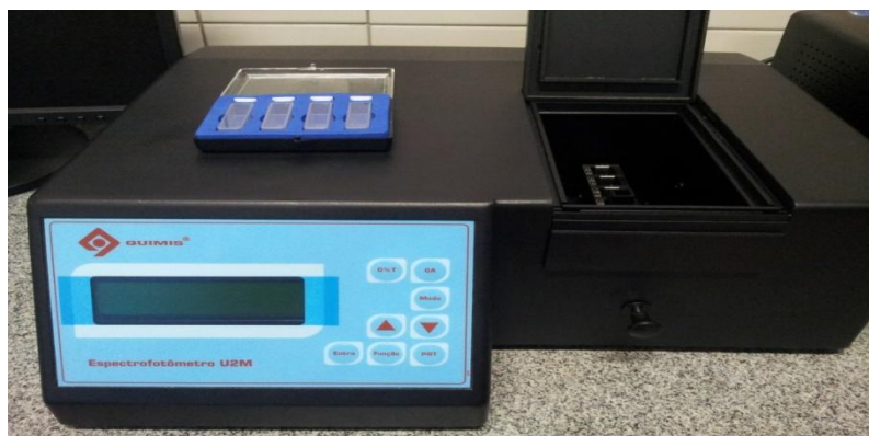
Figura 15. Espectrofotômetro UV-VIS usado para medições da amostra de OE. Foto- Jason J. Atoche.
