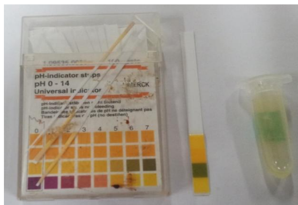
Figura 14. Papel tornasol utilizado para medir o valor do pH. Foto- Jason J. Atoche
