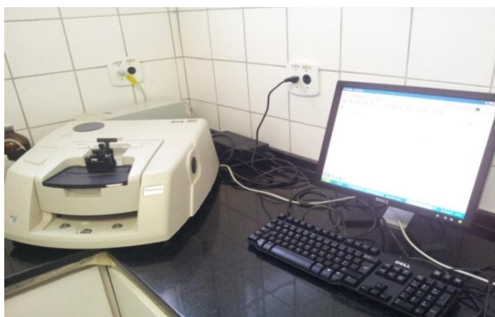
Figura 16. FT-IR usado para verificar os grupos funcionais do OE. Foto- Jason J. Atoche.
