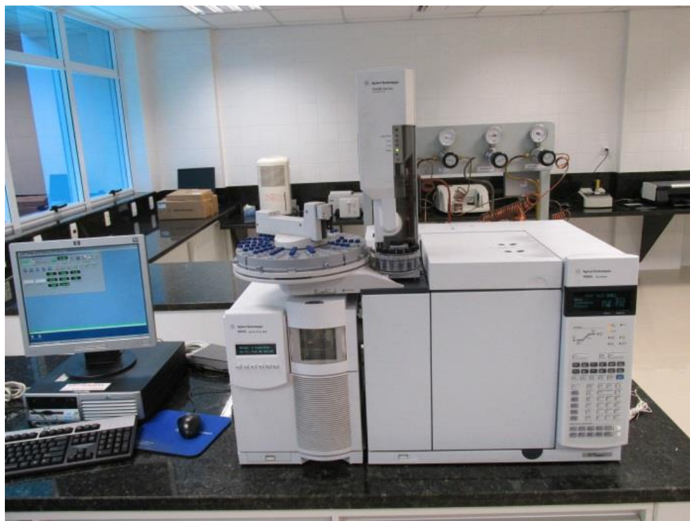
Figura 13. Cromatógrafo a gás em interface com um detector seletivo de massa.
