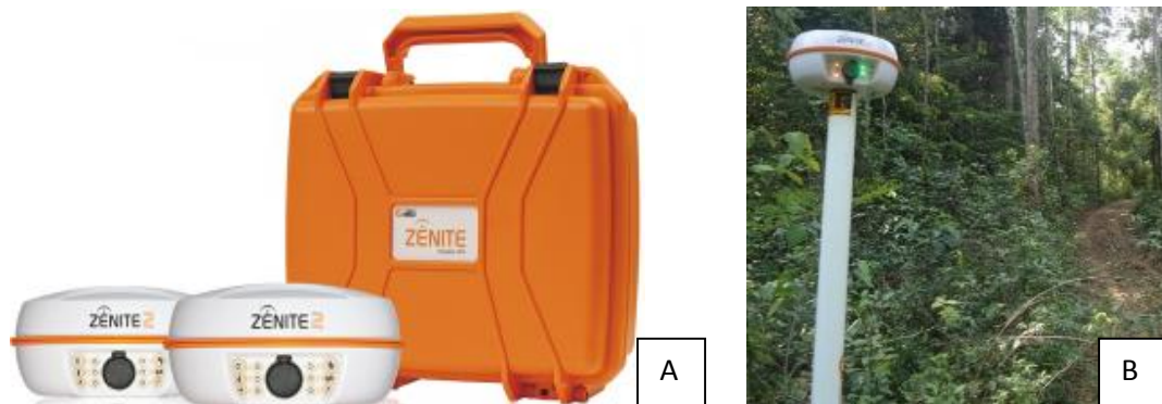
Figura 5 - Aparelho utilizado para realizar leitura dos vértices dos pátios de estocagem. (A), modelo Zênite; (B), obtendo informações dos vértices dos pátios de estocagem. Fonte (A): http://site.techgeo.com.br/produtos/zenite2
