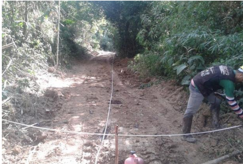
Figura 6- Medição das aberturas nas estradas florestais na área de manejo florestal da FEA, 2013.
