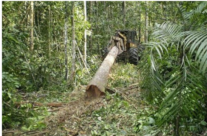
Figura 2- Trilha de arraste principal aberta com a utilização do trator florestal (Skidder). Fonte: www.revistaplaneta.com.br
