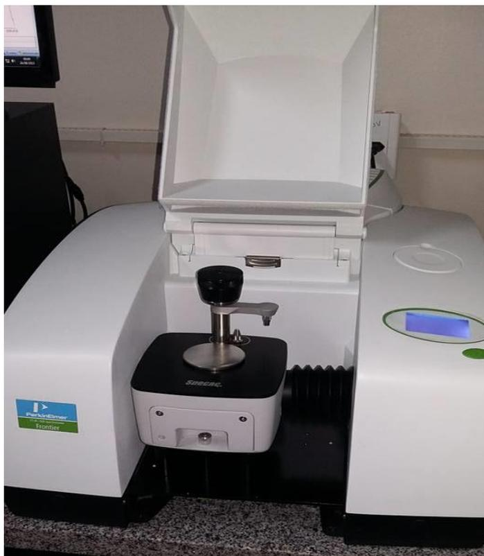
Figura 7 – Equipamento espectrômetro de Infravermelho.
