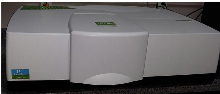
**Figura 6** – Espectrômetro UV-Visível Lambda 950.
