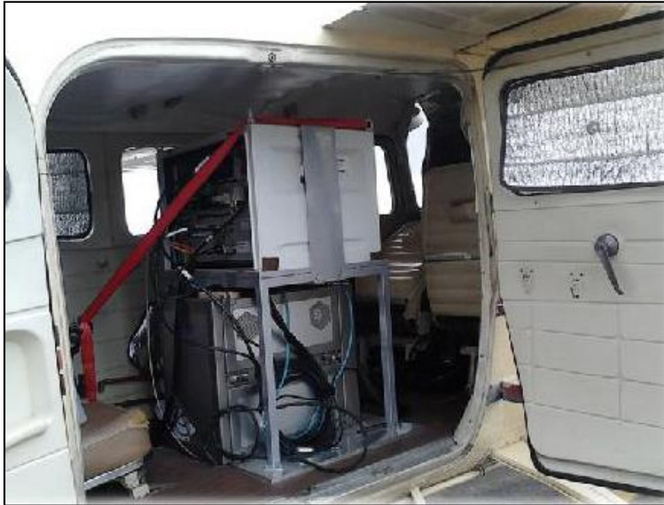
Figura 5 – Sensor LIDAR Aerotransportado Harrier 68i instalado na aeronave Cessna-206.
