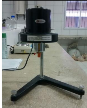
FIGURA 9 - Viscosímetro utilizado no estudo.
