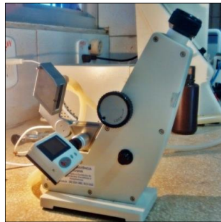
FIGURA 10 - Refratômetro utilizado no estudo.
