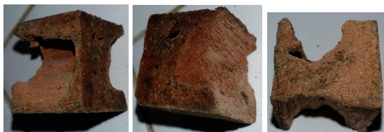
FIGURA 28 - Corpos de prova de Guarea sp. , atacados por cupins durante exposição ao ambiente.
