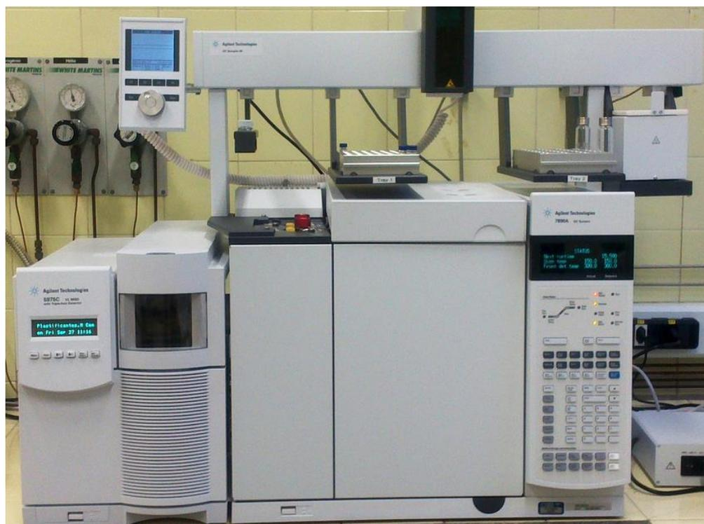
**Figura 15.** Cromatógrafo gasoso acoplado à espectrômetro de massas – CG/EM.
