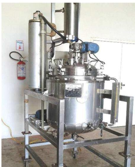
**Figura 11.** Reator de processo encamisado de 50L.
