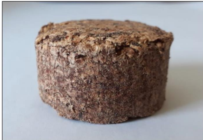
Figura 37 - Falha nas arestas de amostra do pré-teste com tratamento de 30s de prensagem
