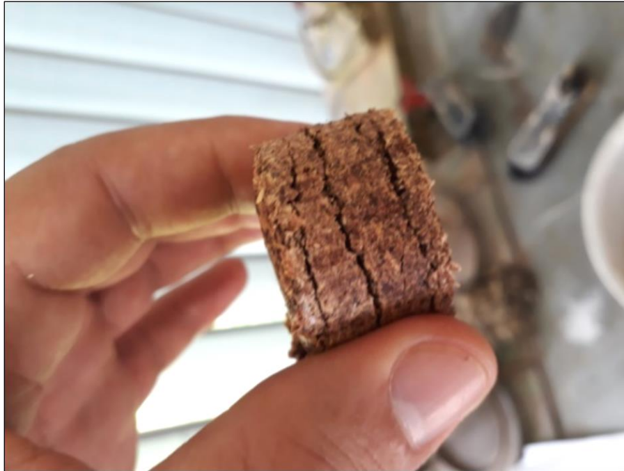
Figura 35 - Rachaduras em amostra de pré-teste de tratamento com pré-aquecimento
