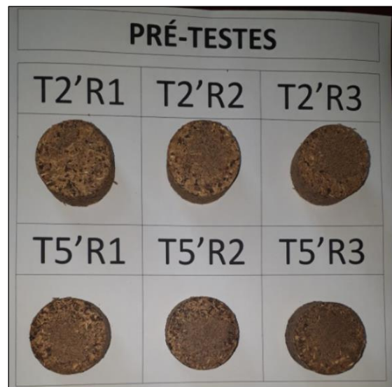
Figura 41 - Amostras de tratamentos com correção dos teores de umidade das biomassas
