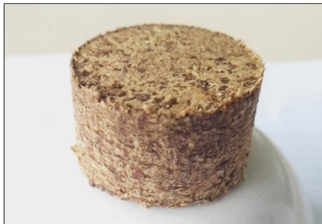
Figura 36 - Microfissuras em amostra de pré-teste de tratamento sem pré-aquecimento
