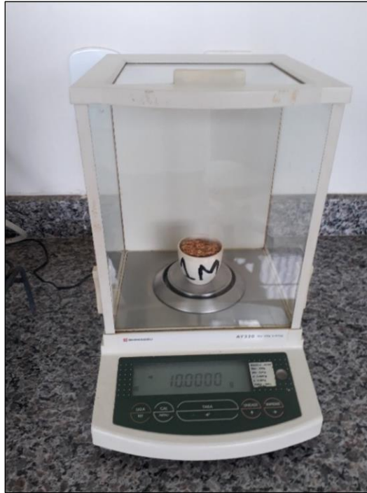
Figura 15 - Balança analítica no momento da pesagem da biomassa dentro do cadinho
