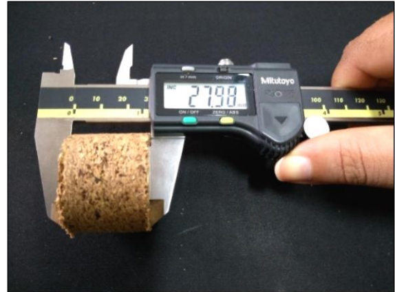
Figura 26 - Verificação da altura da amostra produzida
