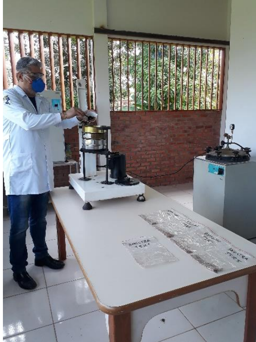
Figura 14 - Conjunto de peneiras sendo preparadas para classificação granulométrica
