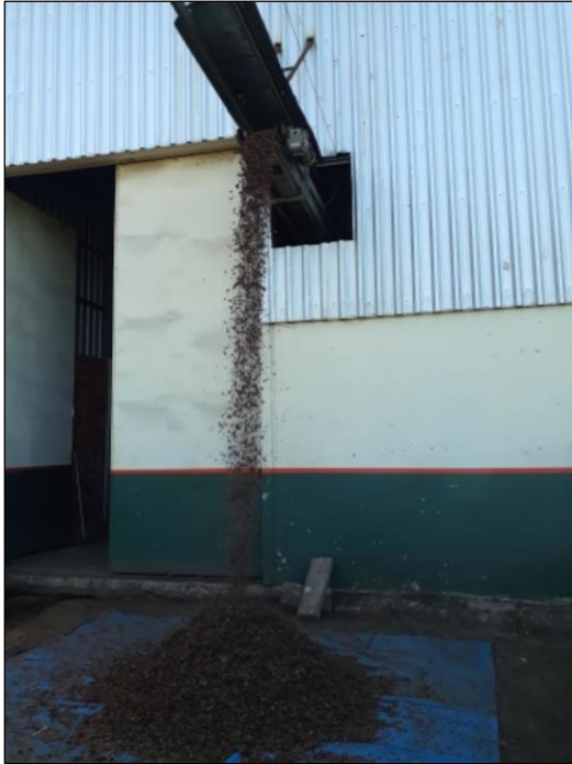
Figura 6 - Correia transportadora despejando a casca da castanha-do-brasil
