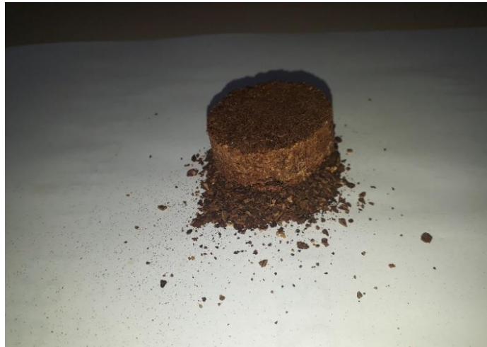
Figura 38 - Amostra oriunda de 100% de casca da castanha-do-brasil
