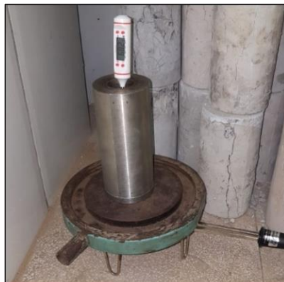
Figura 19 - Rabicho em aquecimento e termômetro tipo espeto aferindo a temperatura
