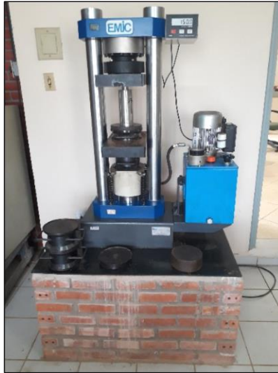
Figura 24 - Prensa hidráulica do Laboratório de Ensaio em Cerâmica
