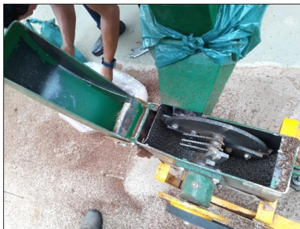
Figura 12 - Detalhe da peneira instalada abaixo do eixo de lâminas de trituração
