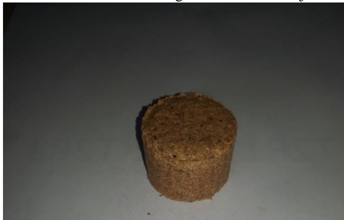
Figura 39 - Amostra oriunda de 100% de serragem da madeira de jacarandá
