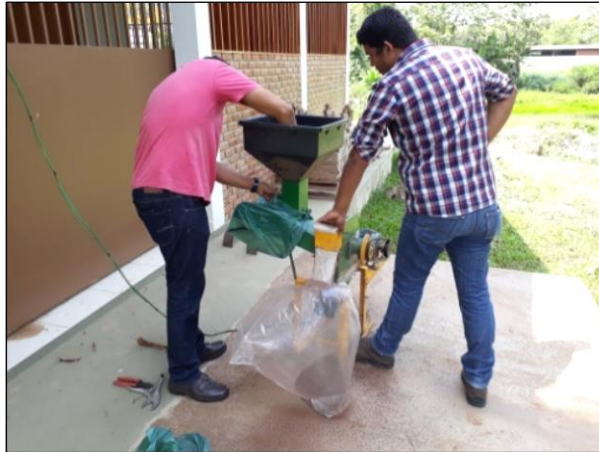
Figura 11 - Momento do preparo do equipamento para a trituração das biomassas
