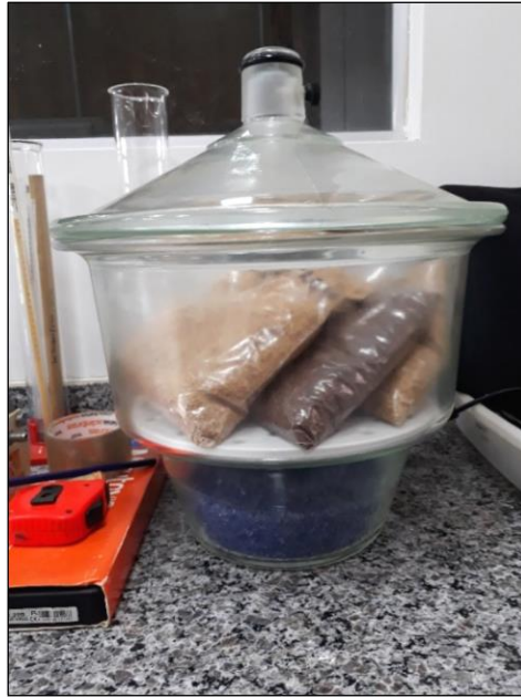
Figura 22 - Biomassas armazenadas para pernoite dentro de dessecador com sílica gel
