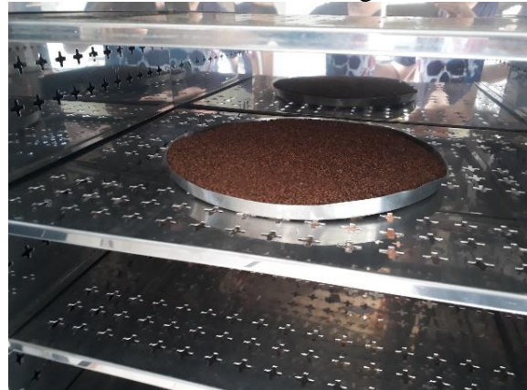
Figura 21 - Biomassa da casca da castanha-do-brasil no momento da secagem na estufa
