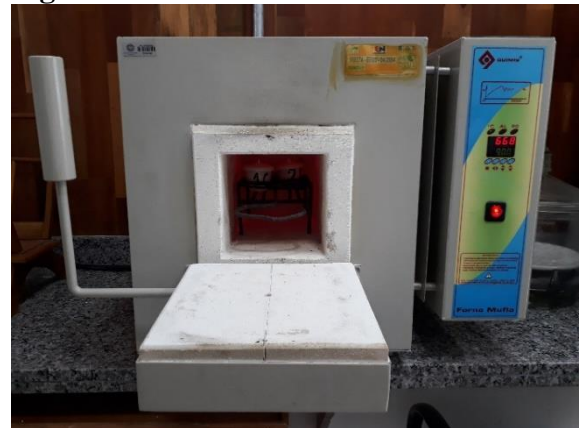
Figura 32 - Cadinhos no interior do forno
