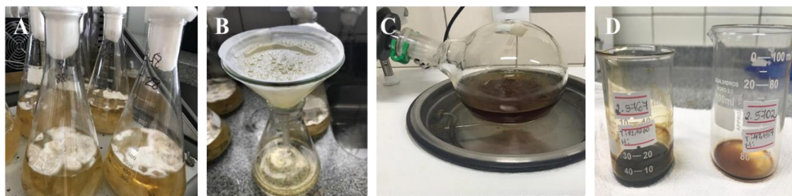
Figura 7. Produção em larga escala de extratos metabólitos de fungos endofíticos de bambu Guadua spp.; A. Crescimento dos fungos endofíticos em meio líquido BD por 14 dias; B. Filtragem dos extratos para separação do micélio fúngico; C. Partição líquido-líquido com acetato de etila; D. Extratos metabólitos na concentração 1:1.
