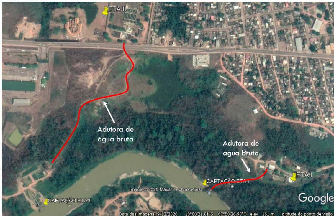
Figura 6: Identificação das ETAs I e II com suas respectivas torres de captação de água bruta.
