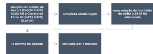
Figura 3. Esquema da síntese da nanopartícula de ferro.
