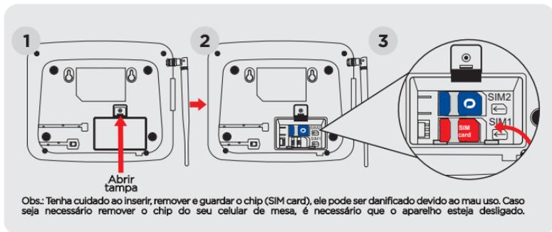
Obs.: Tenha cuidado ao inserir, remover e guardar o chip (SIM card), ele pode ser danificado devido ao mau uso. Caso seja necessário remover o chip do seu celular de mesa, é necessário que o aparelho esteja desligado.
