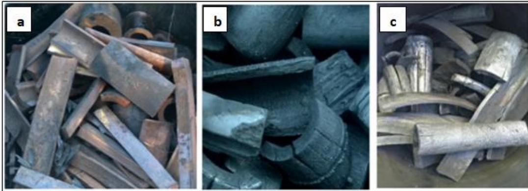
Figura 8: Diferença visual na coloração do carvão produzido no processo de abafamento e no reator tipo retorta. (a) bambu semicarbonizado frequente no processo por abafamento, (b) carvão preto obtido em ambos processos, (c) carvão “branco” produzido em alta temperatura obtido somente no reator tipo retorta. Fonte: fotos dos(as) autores(as).
