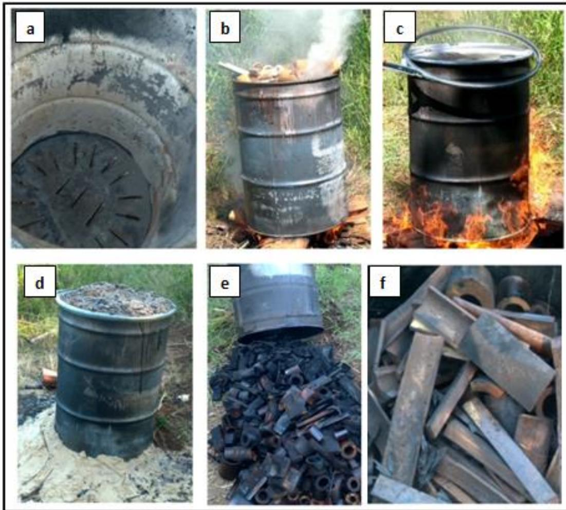
Figura 3: Processo de abafamento em tambor. (a) interior do tambor, detalhe da grelha ao fundo, (b) carregamento e ignição, (c) fechamento com tampa e abraçadeira de aço, (d) vedação da base com areia, (e) carvão heterogêneo produzido, (f) detalhe de peças de bambu semi carbonizadas.
