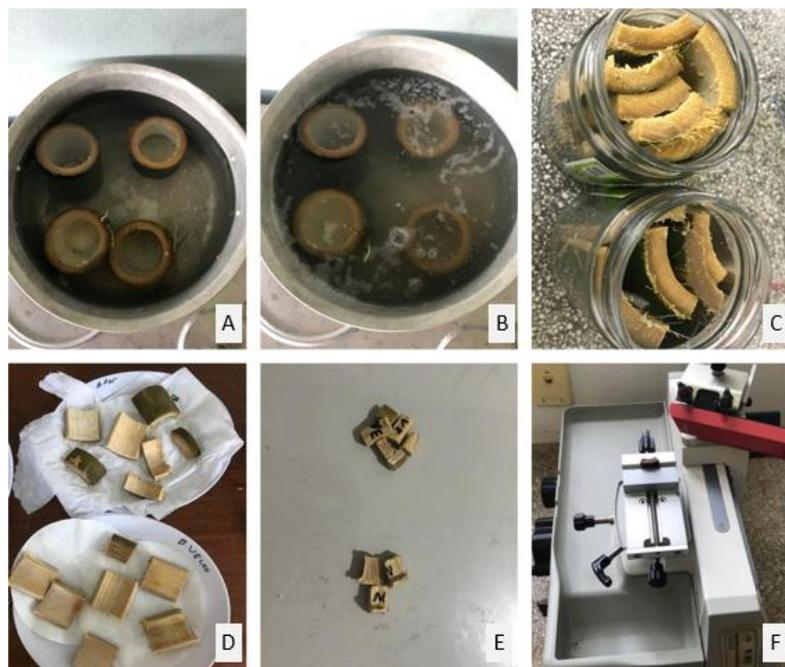
Figura 1 - A) fragmentos do colmo do bambu antes do molho; B) depois do molho; C) fragmentação e acondicionamento em potes de vidro com álcool 70% para cozimento em autoclave; D) padronização do comprimento do comprimento; E) padronização da largura; F) Micrótomo de deslizamento utilizado para os cortes anatômicos. **Fonte:** fotos dos(as) autores(as)
