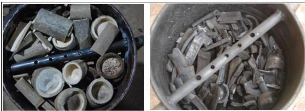
Figura 9: Reator portátil tipo retorta de tambor de aço mostrando a carga fresca de bambu e depois com o carvão produzido. Fonte: fotos dos(as) autores(as).
