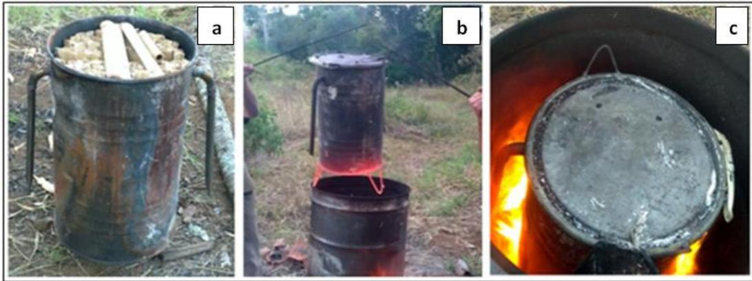
Figura 7: Tambor reator de 40 litros com queimadores tubulares. (a) aberto com carga fresca, (b) sendo retirado do tambor carcaça com o fundo incandescente, (c) detalhe das chamas dos queimadores. Fonte: Ostapiv et al. (2021).
