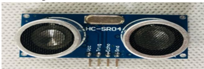
Figura 2: Sensor de ultrassom HC-SR04
