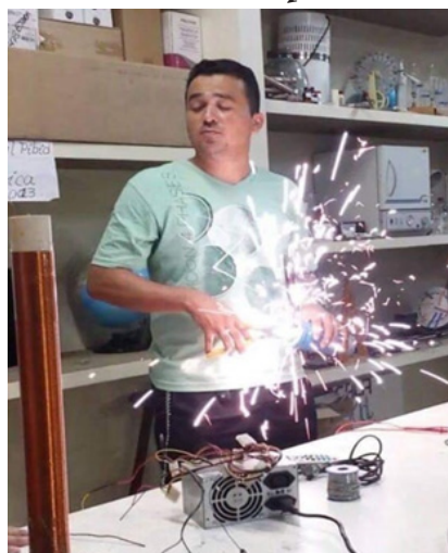
Figura 4: Curto-circuito em um capacitor de 20mF carregado
