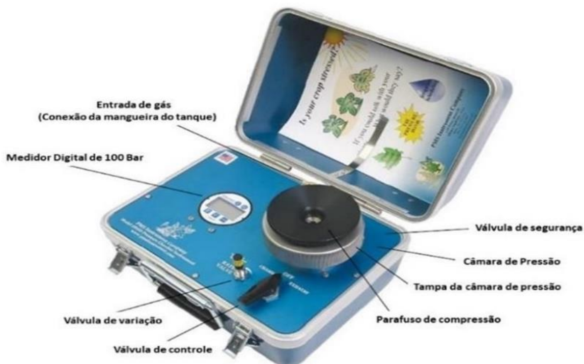
Fig. 2 Câmara de pressão de Scholander (Model 1505D, PMS Instrument Company) utilizada para aferir o potencial hídrico das plantas (Extraído de: Operating Instructions Model 1505D Pressure Chamber Instrument).
