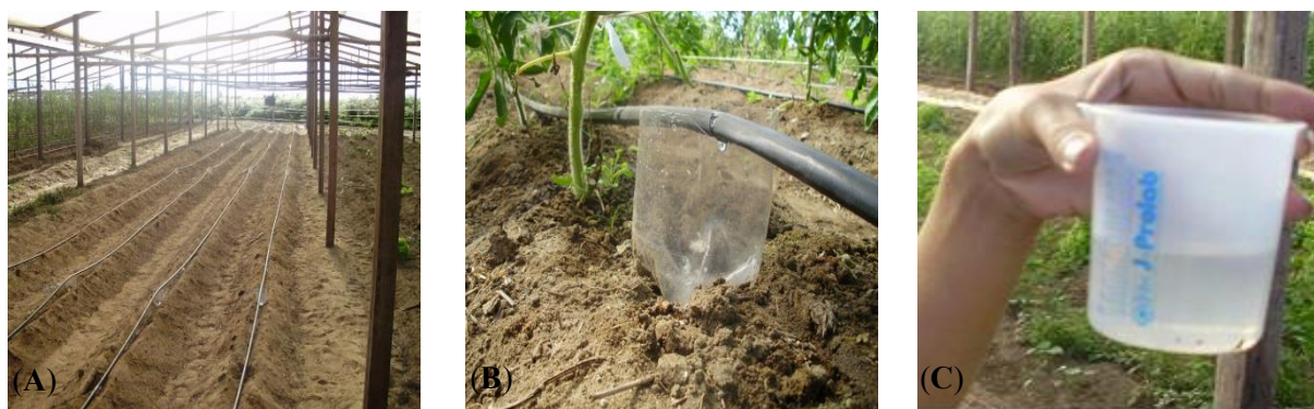
Figura 2. Distribuição dos coletores de água nas linhas laterais (A), coleta de água no gotejador (B) e medição do volume coletado (C) em uma das propriedades rurais do município de Mâncio Lima/Acre em 2013.
