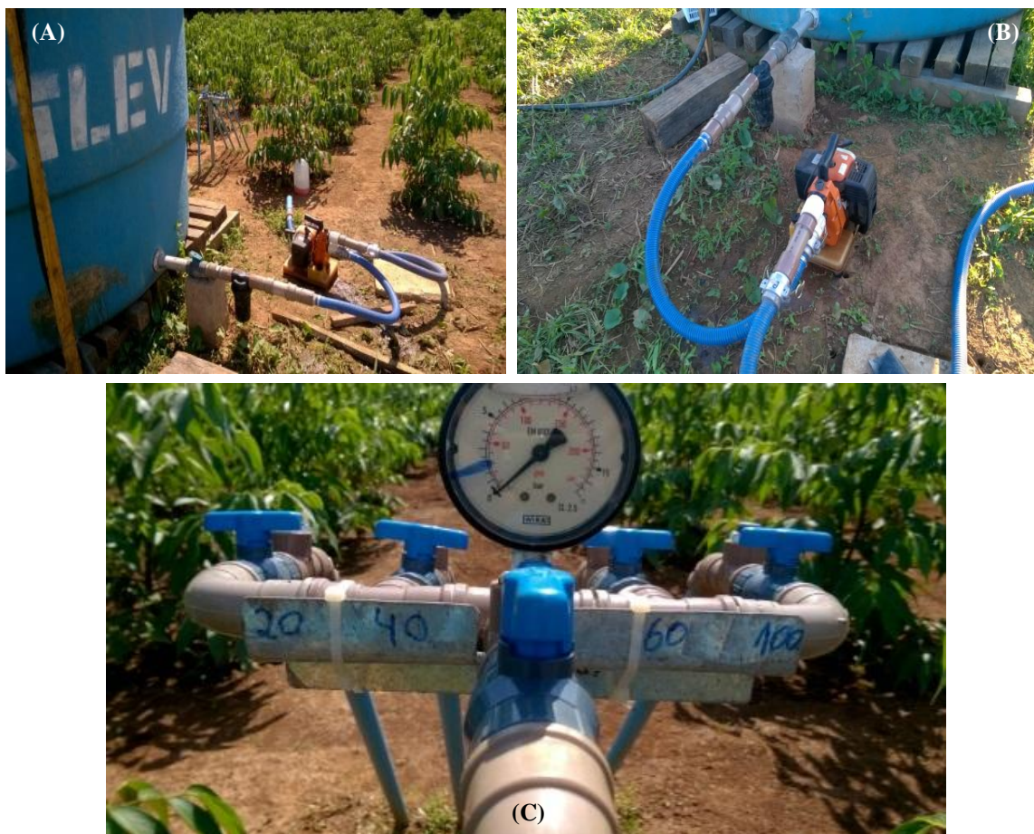
Figura 6. Vista do conjunto motobomba à combustão utilizado no sistema de irrigação por gotejamento (A e B). Central de comando e manômetro para indicar a pressão de funcionamento do sistema de irrigação e válvulas para abertura e fechamentos individuais para cada tratamento (C). Fonte: Leonardo Paula de Souza.
