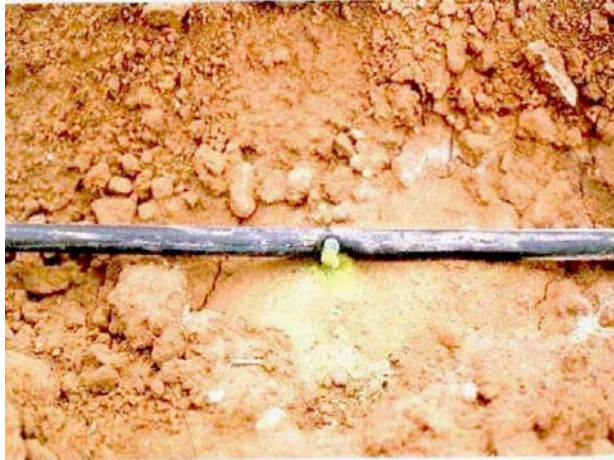
Figura 5.16 – Gotejador obstruído por bactéria
