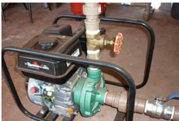
Figura 1.37 - Conjunto motobomba a combustão.
