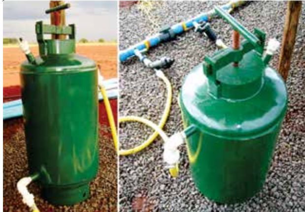
Figura 4.20 - Sistema de injeção de fertilizante por tanque pressurizado.
