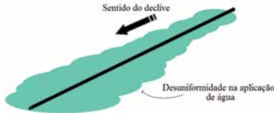
Figura 3.7 - Desuniformidade na aplicação de água de emissores convencionais em área com desnível.
