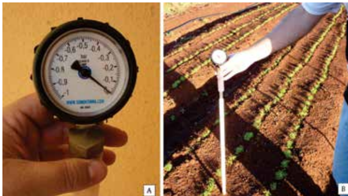
Figura 4.33 – Tensímetro mecânico em detalhe (A) e em funcionamento (B).
