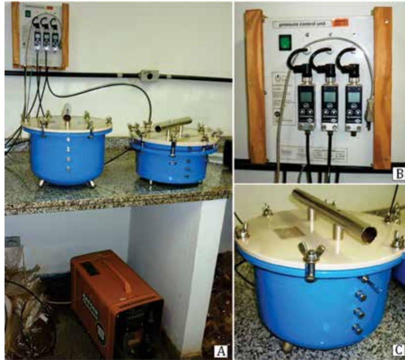
Figura 7.9 - Extrator de Richards: conjunto completo (A), unidade de controle de pressão (B) e câmara de extração (C).
