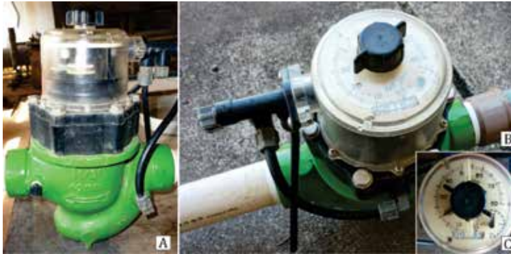
Figura 8.4 - Válvula volumétrica: vista lateral (A), superior (B) e em detalhe (C).
