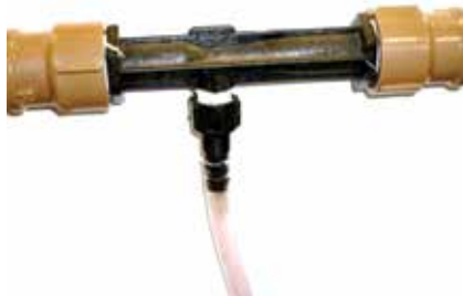
Figura 4.3 - Injetor tipo Venturi em funcionamento
