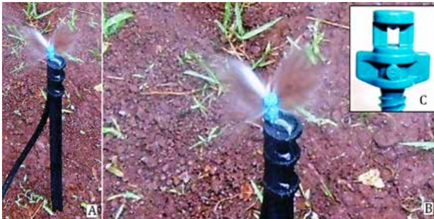
Figura 1.18 - Spray Micro Jet em funcionamento (A e B) e em detalhe(C).
