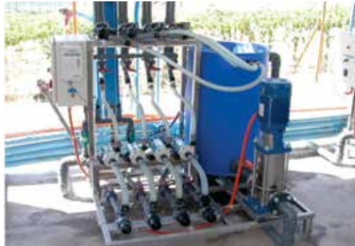
Figura 8.13 - Equipamento utilizado para automação em fertirrigação.
