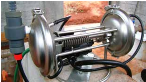
Figura 1.35 - Injetor de fertilizantes do tipo bomba de diafragma com acionamento hidráulico.
