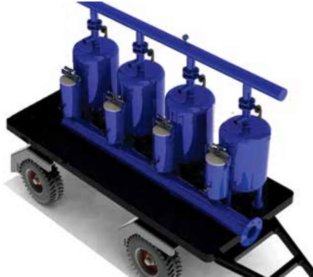
Figura 10.5 - Filtros de areia e discos sobre carreta.
