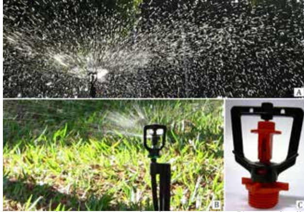
Figura 1.12 – Microaspersor: em funcionamento (A e B) e em detalhe (C).
