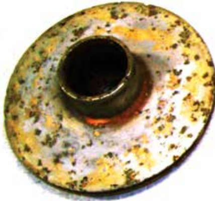
Figura 9.19 - Danos em um rotor fechado devido à cavitação.
