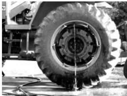
Bico a 90^{\circ} em Relação ao Solo Adição de 75 % de Água no Pneu
