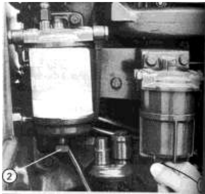
Drenagem do Sedimentador
