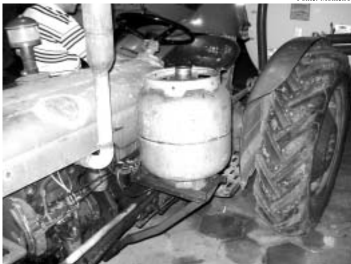
Tanque de combustível improvisado
