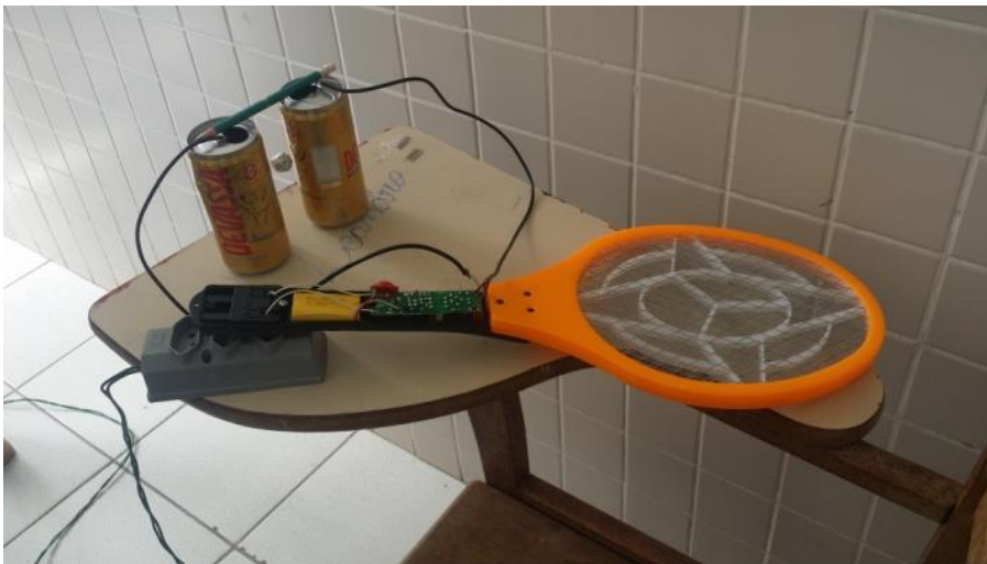
Figura 18: Motor eletrostático. Fonte: Autora do trabalho.
