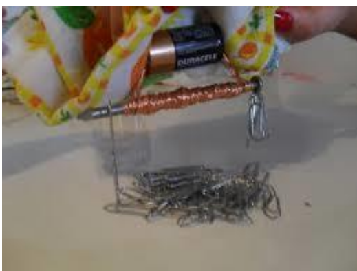
Figura 31: Eletroímã. Fonte: http://fisica-mooderna.blogspot.com.br/2012/03/relatorio-do-eletoima-de-prego.html
