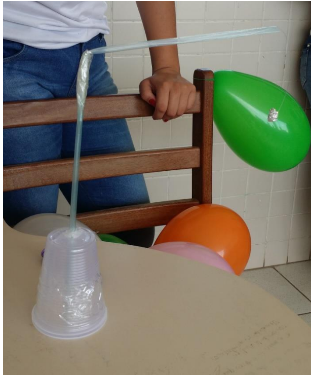
Figura 13: Pêndulo eletrostático confeccionados pelos alunos do CEJA.
