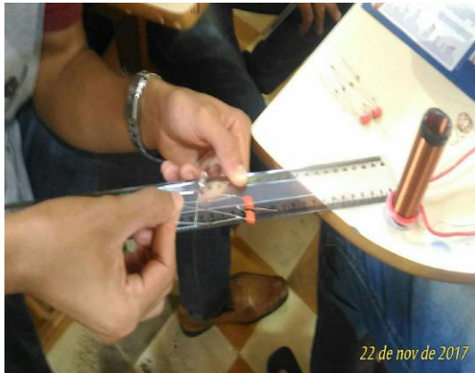
(c) Medição da voltagem do sinal da onda eletromagnética em função da distância.
