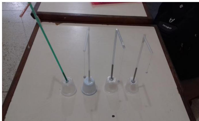
Figura 2.10: Pêndulo Eletrostático Confeccionado Pelos Alunos. Fonte: Arquivo pessoal.
