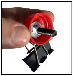
Figura 8 – Porca inserida no parafuso. Fonte: o autor (2021).
