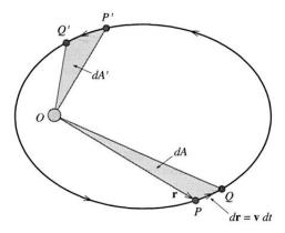
Figura 11 - De acordo com a segunda lei de Kepler, o vetor posição indo de P a Q varre a mesma área que o vetor posição de P' indo até Q' caso tenha decorrido o mesmo intervalo de tempo. Fonte: Taylor (2013).
