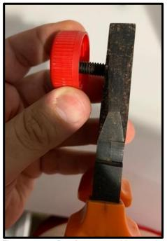
Figura 3 – Parafuso aquecido sendo pressionado contra a superfície da tampa com o auxílio do alicate. Fonte: o autor (2021).
