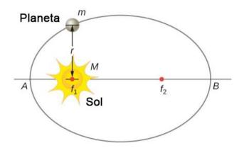
Figura 73 – A primeira lei de Kepler afirma que a órbita dos planetas é elíptica e o Sol ocupa um dos focos. Fonte: Rice University (2021).
