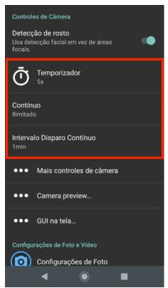
Figura 54 – O temporizador deve ser definido para 5 segundos, o contínuo para ilimitado e o intervalo ser de 1 minuto. Fonte: o autor (2022).
