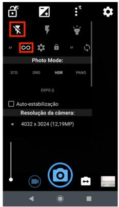
Figura 56– O *flash* deve ser desativado o foco ajustado para infinito. Fonte: o autor (2022).
