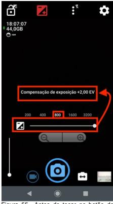
Figura 55– Antes de tocar no botão de disparo, a compensação de exposição deve ficar no máximo e o valor de ISO 800. Fonte: o autor (2022).
