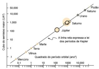
Figura 76 – Um gráfico mostrando a relação linear entre o cubo do semieixo maior da órbita de cada planeta em torno o sol e o quadrado do período orbital. Fonte: Georgia State University (1999).
