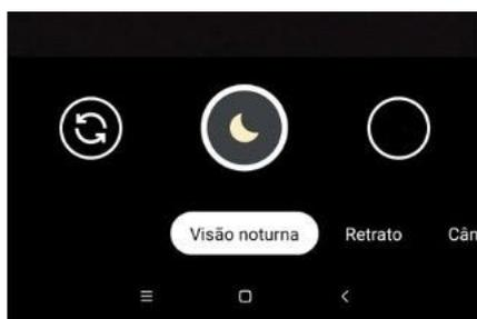
Figura 37 – Os modos de fotografia podem ser escolhidos ao rolar com o dedo horizontalmente, na parte de baixo da tela. Fonte: o autor (2022).
