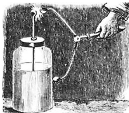
Figura 3: ilustração de uma garrafa de Leyden.
