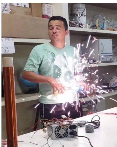
Foto 04: Curto-circuito em um capacitor de 20mF carregado
