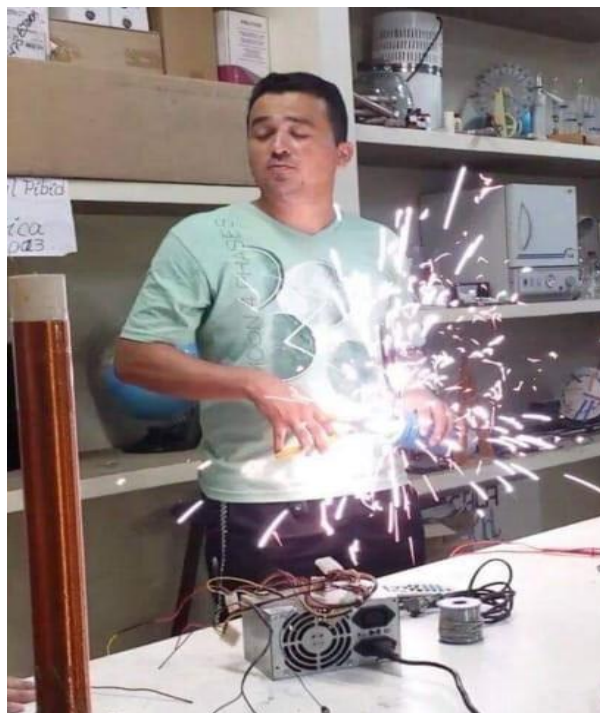
Foto 04: Curto-circuito em um capacitor de 20mF carregado
