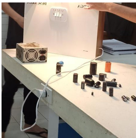
Foto 14: Capacitores de tamanhos diferentes
