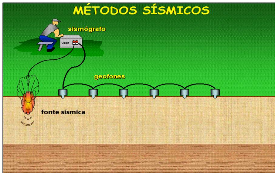
**Figura 3.13:** Sistema para levantamento de dados sísmicos. **Fonte:** Retirada do site Oficina de textos, 2017 – adaptada
