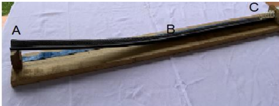
Figura 7: Rampa de Inclinação Variável dotada com mola numa extremidade (C)
