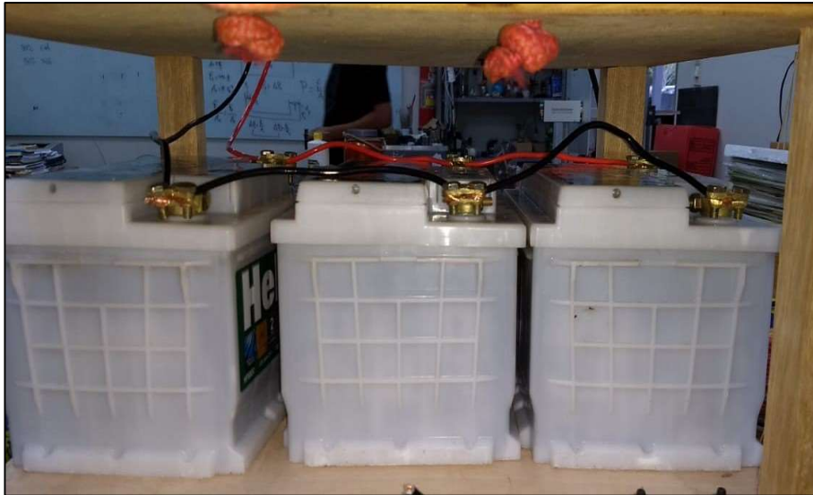
Figura 7. Associação de baterias em série utilizada no trabalho para alimentar o circuito elétrico.
