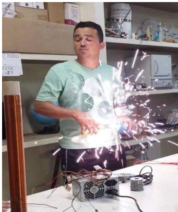
Foto 04: Curto-circuito em um capacitor de 20mF carregado
