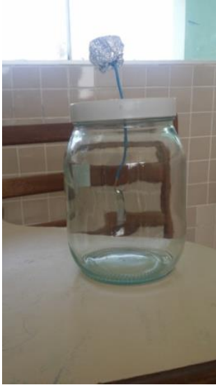
Figura 13: Eletroscópio caseiro. Fonte: Autora do trabalho.
