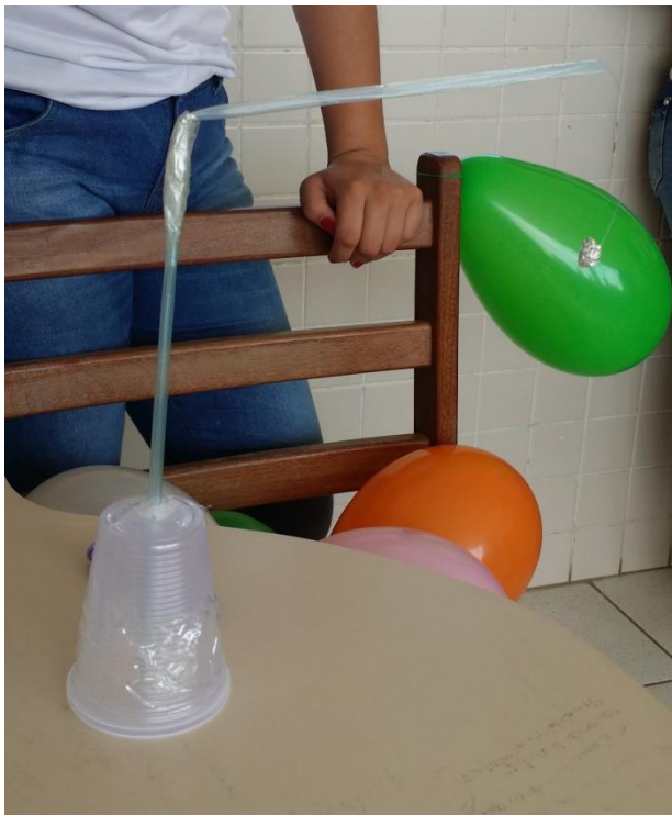
Figura 1: Pêndulo eletrostático confeccionados pelos alunos do CEJA.
