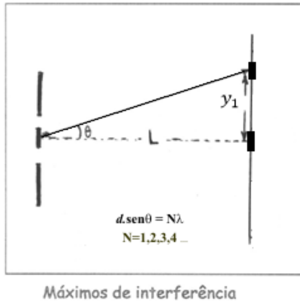
Figura 13. Relação geométrica entre o padrão e a distância (L)
