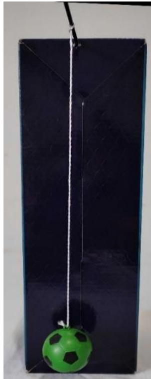
Figura 3. Montagem caseira de um pêndulo simples
