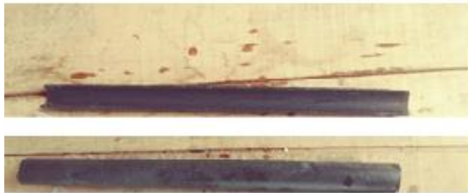
Fig. P9: Tubo de PVC cortado longitudinalmente
