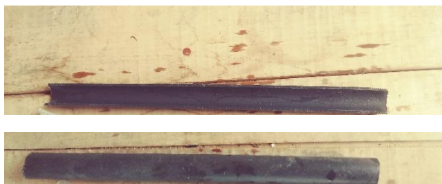
Fig. P19: Tubo de PVC cortado longitudinalmente
