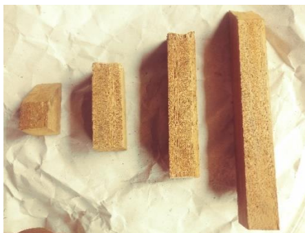
Fig. P14: Espaçadores de madeira
