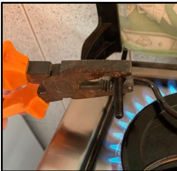
Figura 2 – Parafuso sendo aquecido com o auxílio de um alicate. Fonte: o autor (2021).
