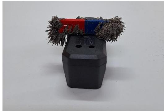
**Figura 3.2b** Limalhas de ferro concentradas nas extremidades do ímã.
