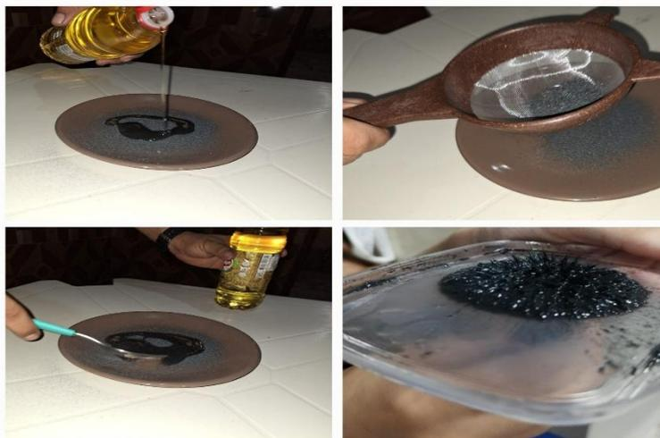
**Figura 5.3** Montagem do ferrofluido caseiro, utilizando o pó da esponja de aço queimada e visualização dos espinhos da mistura com o óleo de cozinha e a interação com um ímã.
