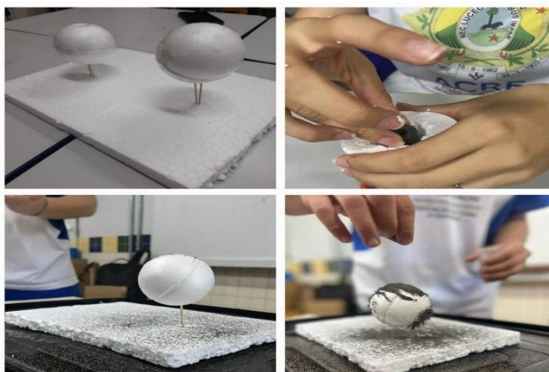
**Figura 5.5** Procedimentos para a visualização das linhas de campo magnético com a inserção de um ímã no centro da bola de isopor.
