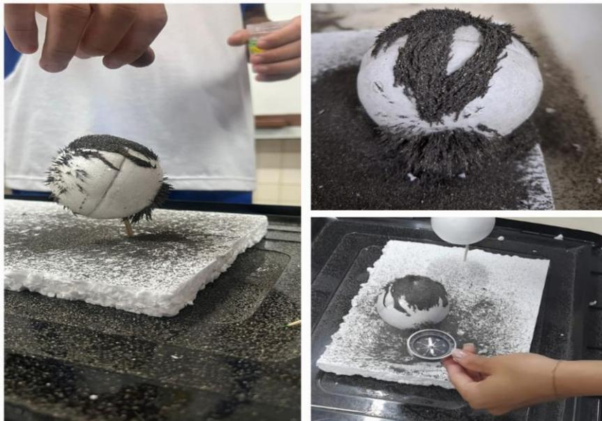
**Figura 5.6** Visualização das linhas de campo magnético e a interação de uma bússola em contato com essas linhas de campo magnético.
