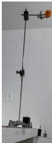
Figura 24 - Arranjo experimental da máquina de Atwood. Fonte: Elaborado pelo autor.
