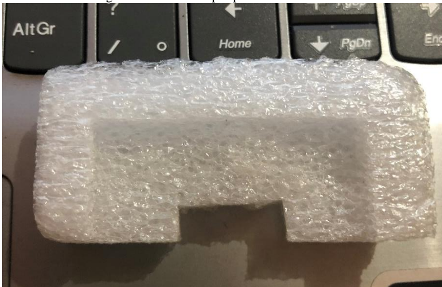
Figura 1: Corte no isopor para encaixe do sensor
