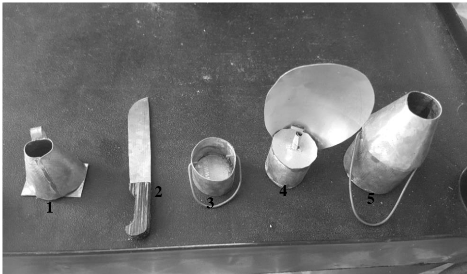
Figura 08: Alguns instrumentos utilizados pelo seringueiro (1) lamparina; (2) facão; (3) balde pequeno, (4) poronga e (5) balde grande;
