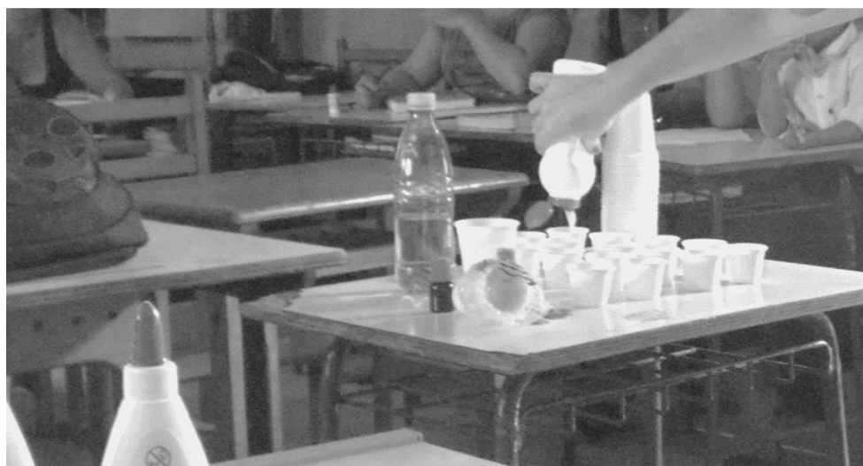
Figura 28: Adicionando cola branca (PVA acetato de polivinila) nos copos de 250ml.
