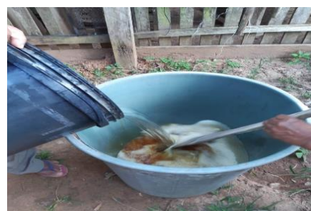
Figura 6: Adição de água fria a mistura de água morna, soda cáustica e óleo usado.
