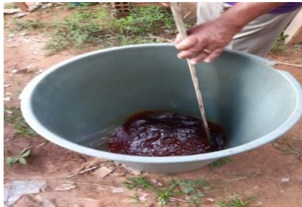
Figura 5: Mistura de água morna, soda caustica e óleo usado.
