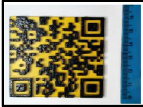
Figura 20 - Código QR fabricado em resina fotopolimérica com dimensões de 6x6 cm
