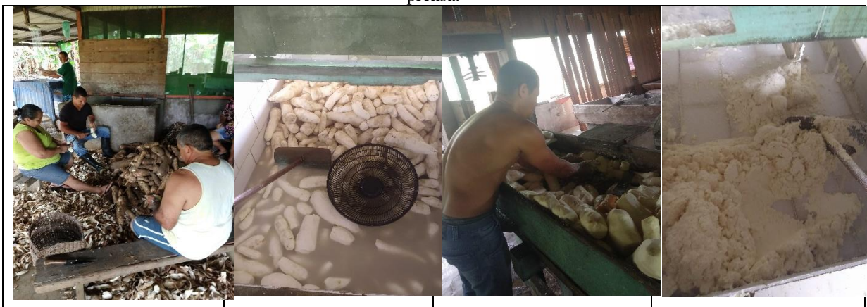
Figura 13: Raspagem da mandioca; lavagem da mandioca; sevagem da mandioca e a massa para colocar na prensa.
