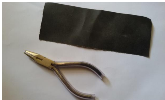
Figura 9. Alicates e lixa utilizados para o acabamento das peças.
