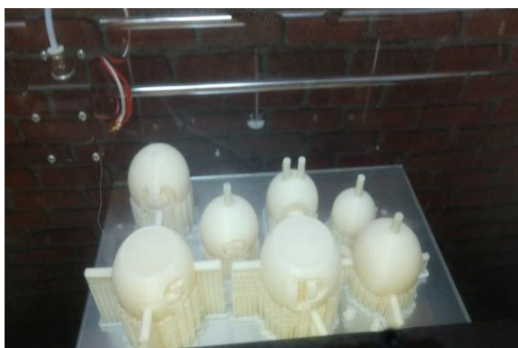
Figura 8. Modelos sendo impressos na impressora 3D
