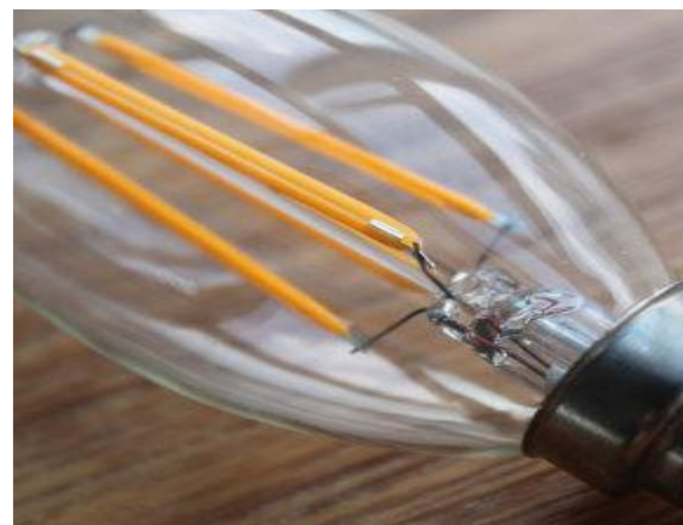
Figura 2. Circuito eletrônico montado em filamentos dentro de uma lâmpada..
