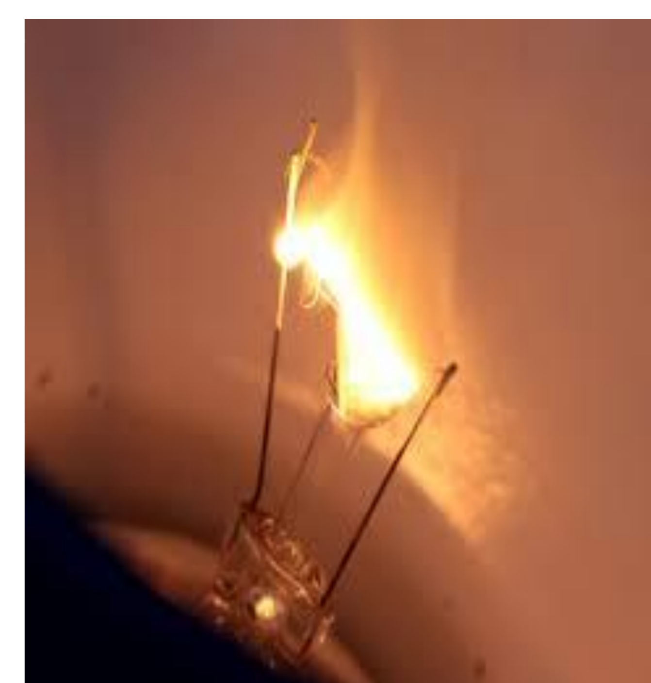
Figura 1. Circuito eletrônico montado com pilhas tamanho grande (esquerda) e a queima da grafite (direita).
