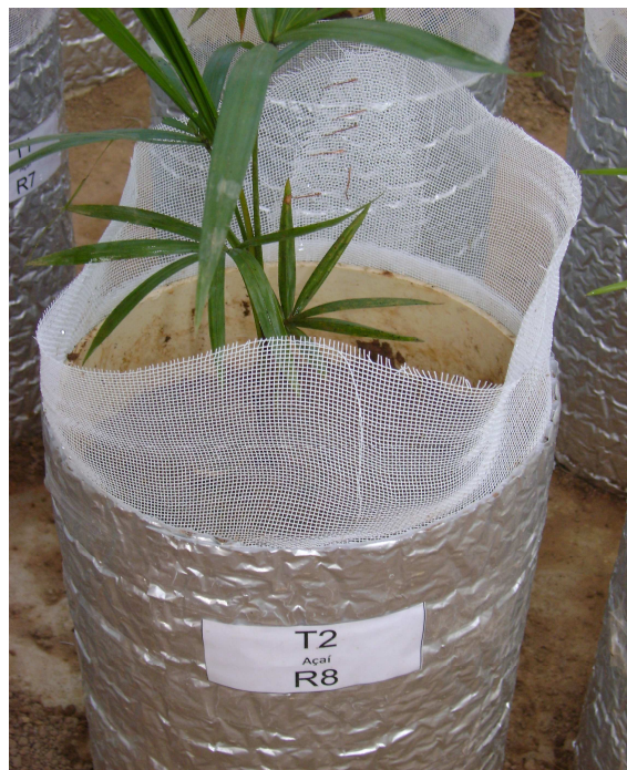
FIGURA 2 - Manta térmica envolvendo o tubo de PVC.
